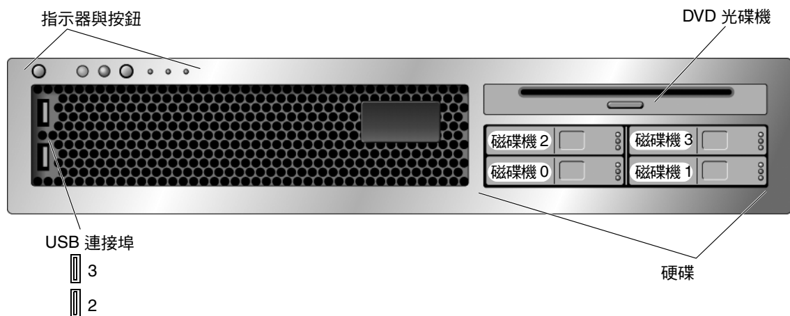
圖 3 SPARC Enterprise T2000 伺服器前方面板
